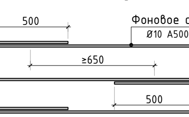
Стыковка арматурных стержней фоновой арматуры внахлестку
