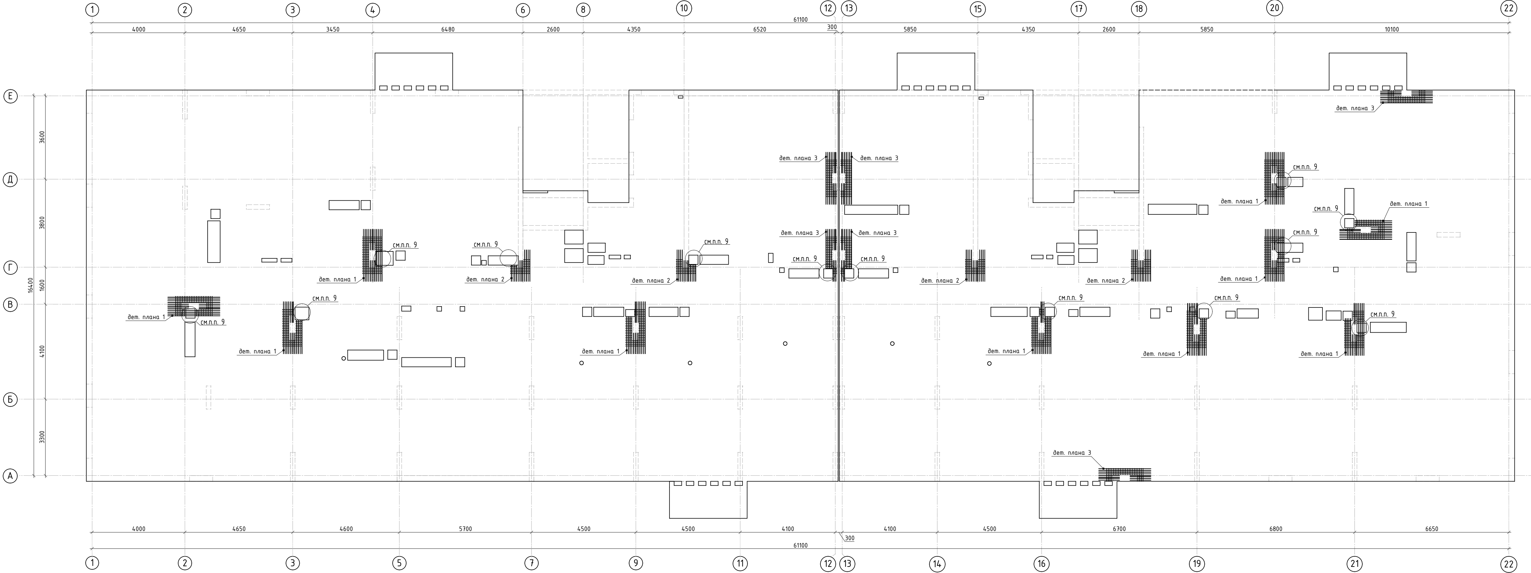
Деталь плана 1 (схема раскладки поперечной арматуры для пилонов)
